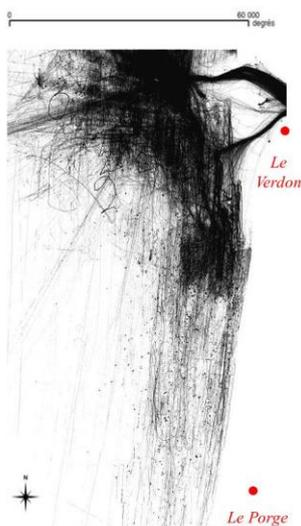
Fig 1 : Représentation cartographique des 7 millions de positions AIS fournies par le GPM de Bordeaux
