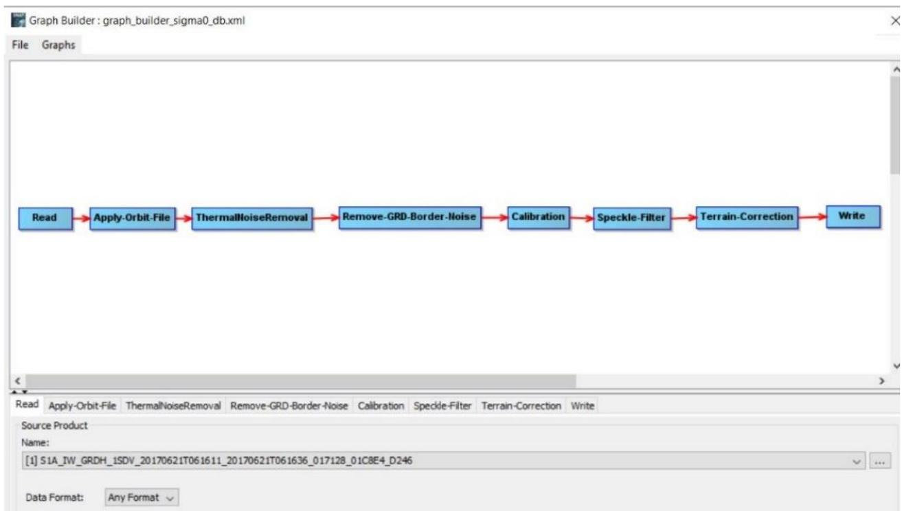
Figure 13 : Construction du *Graph Builder* dans *SNAP* - Prétraitements appliqués aux données Sentinel-1 avant exploitation
