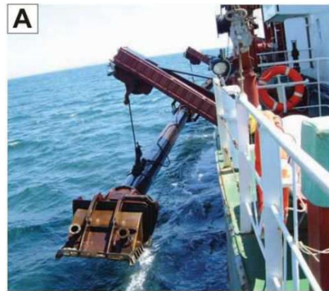
Figure 9 Exemple de la tête d'élinde « fixed visor » utilisée en France issue de Duclos (2012). dont la largeur varie entre 1,5 et 2,5m
