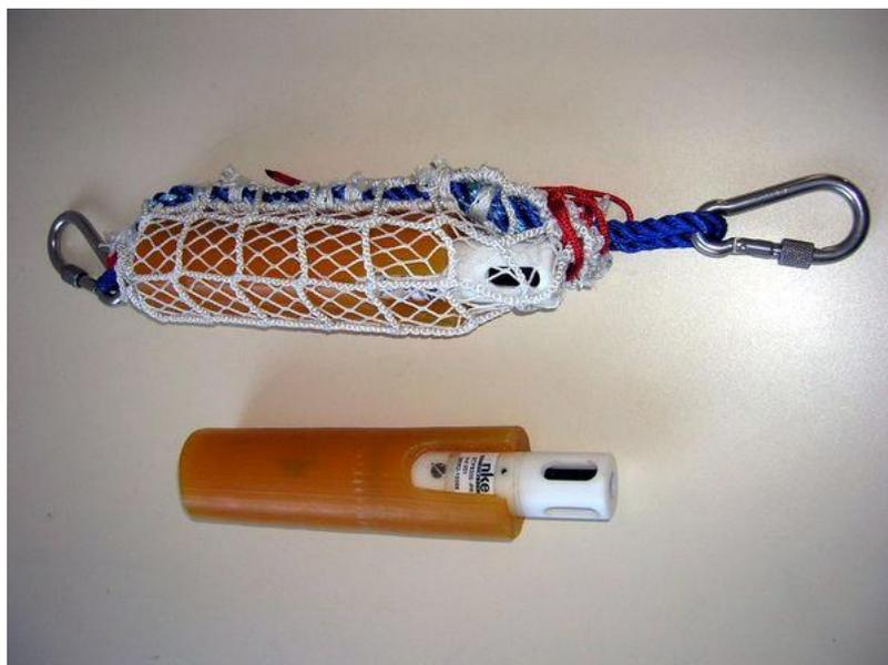
Figure 3 : Capteur SPTS : enregistreur autonome de pression, température et conductivité (217 mm Ø 30 mm), dans son étui de protection, et inséré dans un sac en filet avec mousqueton pour fixer aux engins
