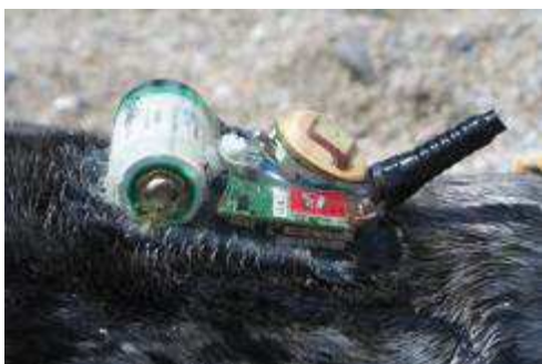
Balise Fastloc GPS/GSM (SMRU) © C. Vincent, LIENSs Université de La Rochelle
