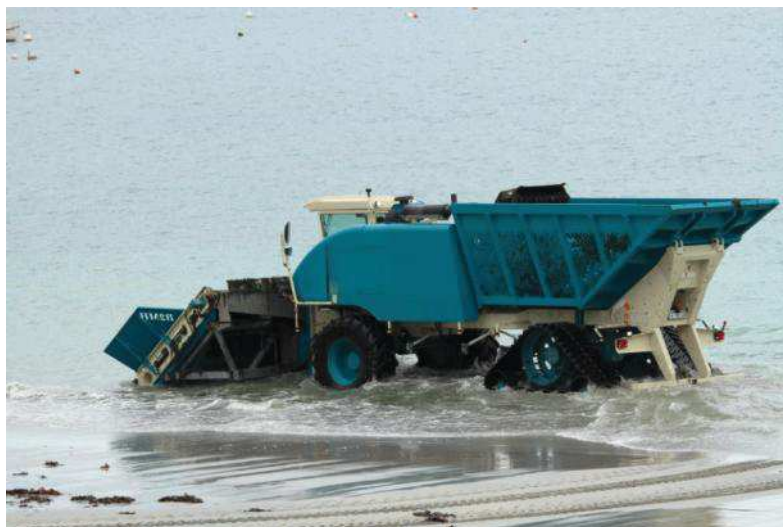
Machine d'AGRIVAL en action de ramassage d'ulves . Laurent PERCHIRIN
